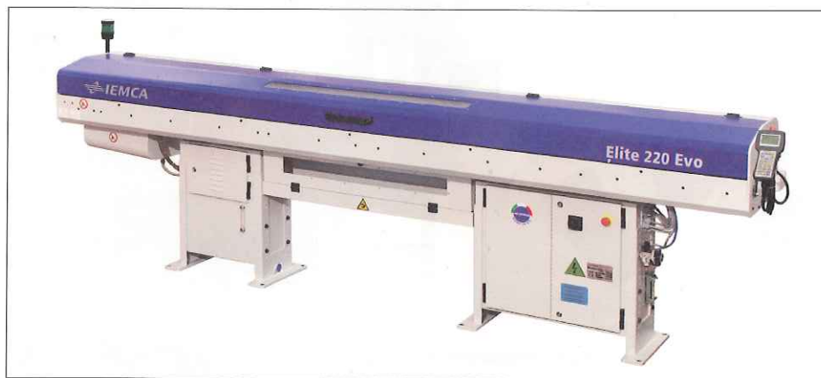
L'embarreur IEMCA Elite 220 dispose de deux types de magasin et d'un dispositif antivibratoire qui assure le support de la barre en rotation reconfiguré automatiquement à chaque changement de série. Source : Bucci Industries
