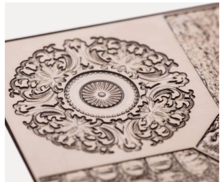
Grâce à la technologie laser femtoseconde, il est possible de texturer de l'acier inox, par exemple. LDD
